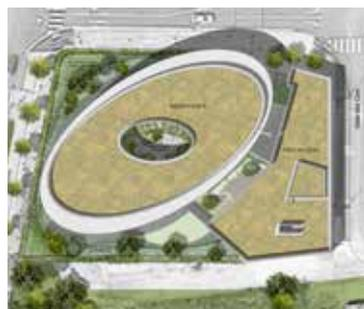
les habitations environnantes. Le double mouvement de la toiture permet de disposer, au nord, d'une casquette de protection aux intempéries, et au sud, d'une protection solaire.
