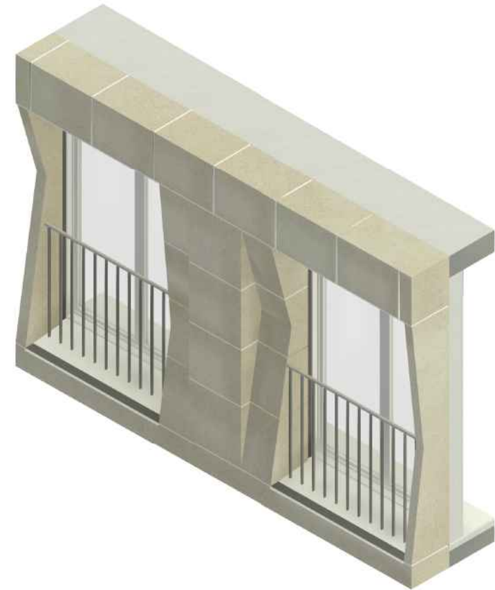
Extrait de la façade en pierre porteuse structurale Pierre de Saint-Maximin - Ferme, fine et adoucie
