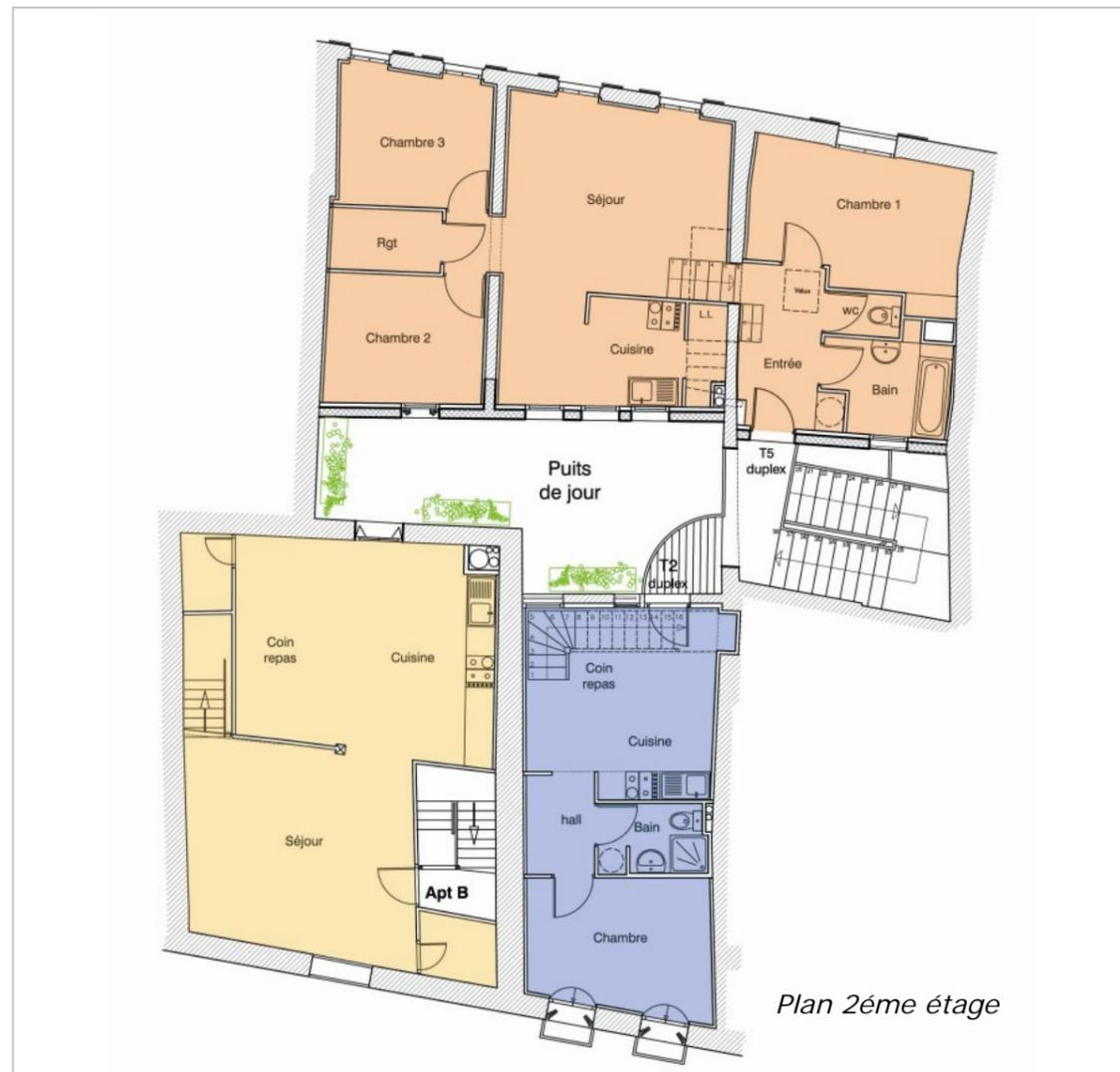
Ce projet est une réhabilitation avec remodelisation de l'aménagement intérieur de 2 immeubles, Place du Puig à Perpignan pour créer, sur 3 niveaux, 5 appartements (T2, T4, T5 et 1 duplex). Une démolition partielle des planchers permet d'ouvrir un puits de jour.
