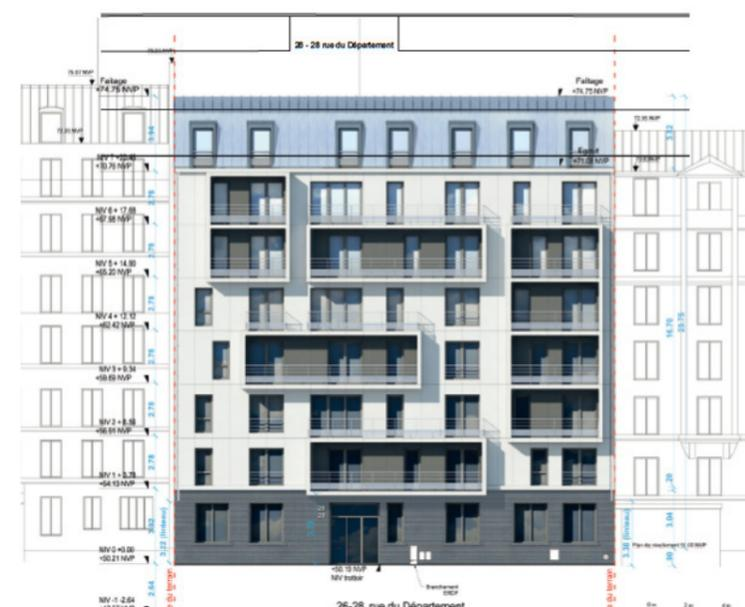
Construction d'un immeuble de 31 logements dans une dent creuse parisienne. Le projet s'insère entre les deux immeubles mitoyens en introduisant une rupture dans le continuum architectural de la rue tout en respectant l'épannelage. Les façades sont constituées de d'un parement en pierre de synthèse posés sur pré-murs, le soubassement revêtu de brique céramique anthracite.
