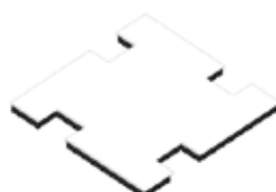
Plexiglass transparent déposé sur les bouchons des bouteilles et gallons pour créer une surface lisse
