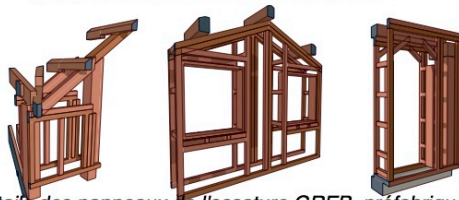
détails des panneaux de l'ossature GREB, préfabriqués sur place par le maître d'ouvrage
