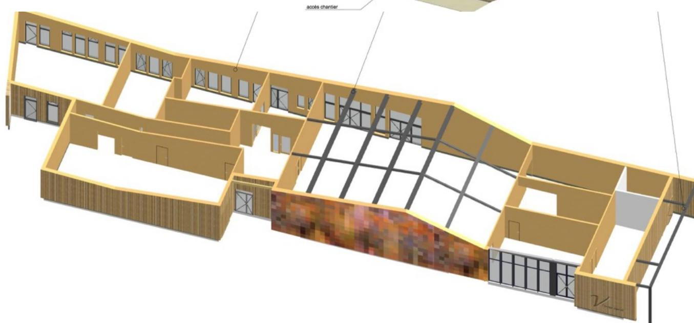
Éléments structurels en panneaux de bois lamellé-croisé, et charpente métallique pour la salle de spectacle
