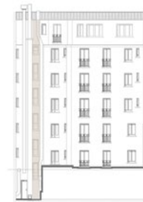
Ravement des façades avec pose ITE
