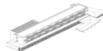
Brises soleils en grumes de bois attachés à la FOB Ajout de préaux
