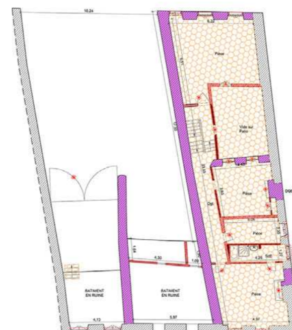
plan du rez-de-chaussée - démolition
