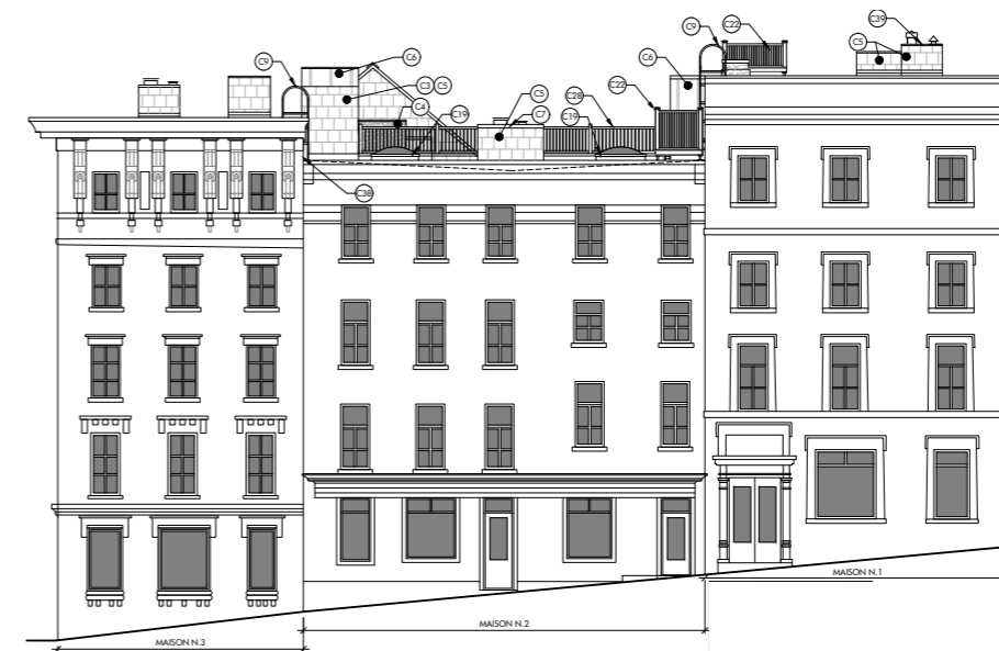
Élévation sur rue et modification en toiture
