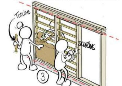
On vient former des «boudins» avec ce mélange, ou des torches (d'ou torchis) pour les enrouler autour du latis, puis remplir le mur au fur et à mesure.
