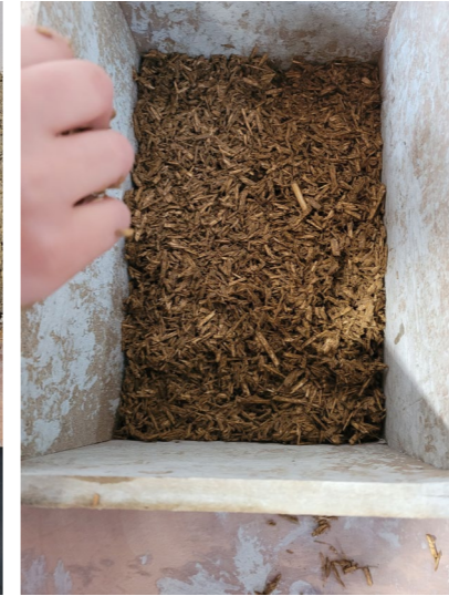
Coffrage briques chanvre
