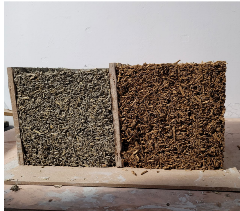
Briques en chanvre décoffrées
