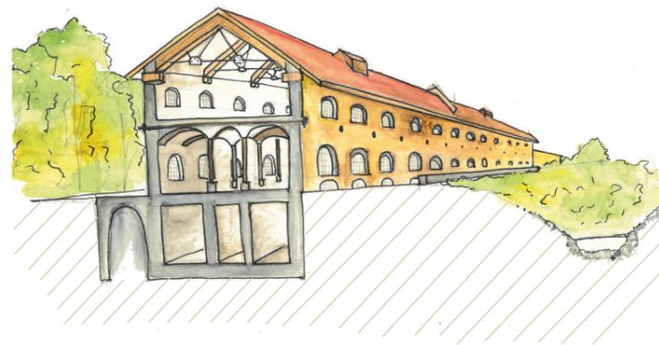
Figure 5.2 : Coupe perspective montrant la structure de la halle marcelline, Maëlle Poussin
