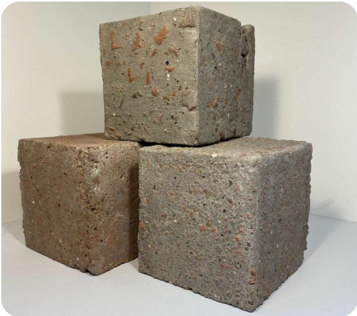
**Prototype d'un matériau de réemploi : le béton de brique**
