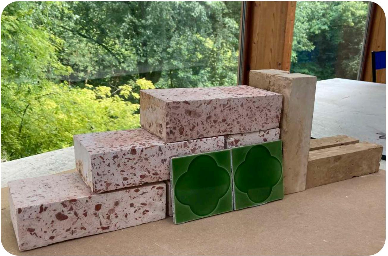
Prototypes de briques en matériaux de réemplois et géosourcées
