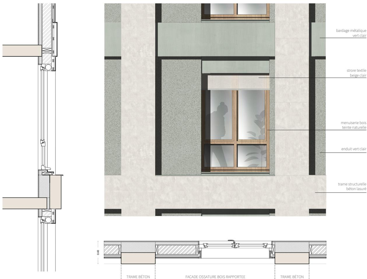
Extrait de façade - Structure porteuse caractérisée par une maille béton
