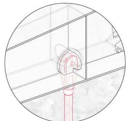
Détail 2 : Accroche du tirants sur la poutre treillis
