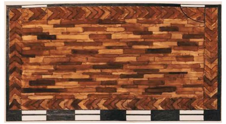
CALEPINAGE DE PLANCHER EN BOIS RÉALISÉ À L'AQUARELLE
